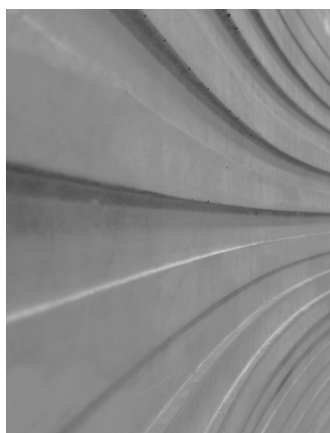
Фото пример бетонной поверхности после распалубки с использованием WABICON HP в качестве разделительного агента
